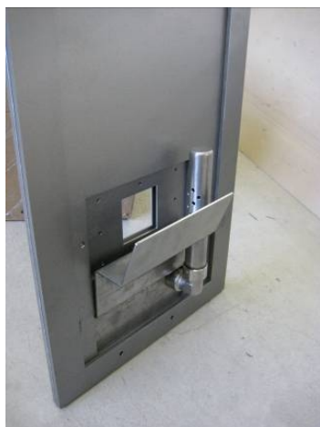
Vista interior com bandeja de recolha e mandril de bocais pneumático
